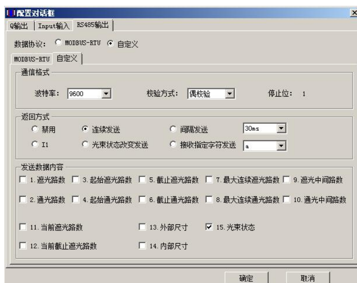
图 9-29 RS485 自定义配置界面
